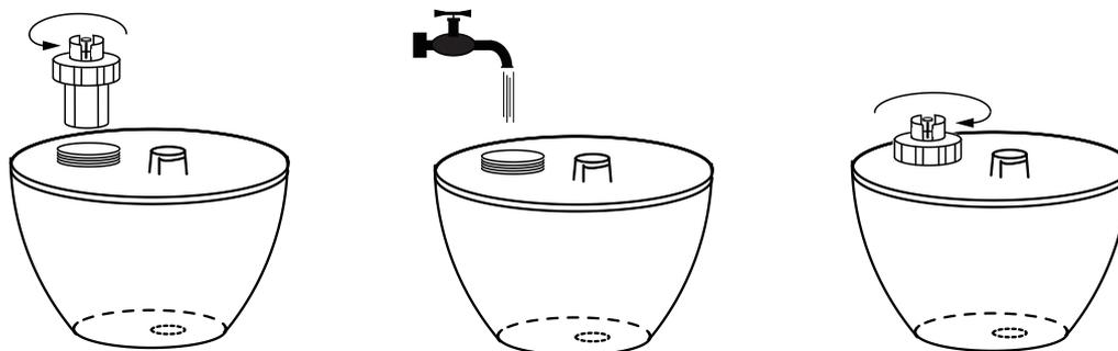
④ タンクを本体にセットし、ミストノズルを取り付けます。
